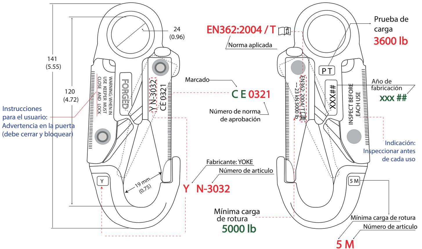
El acero usado, es previamente sometido a un análisis espectrográfico para asegurar, un contenido metalúrgico apropiado. Todos los componentes forjados son sometidos individualmente a una prueba de control Magnaflux para detectar rajaduras.
