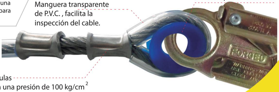
Prensado con férulas de aluminio ( con una presión de 100 kg/cm<sup>2</sup> )
