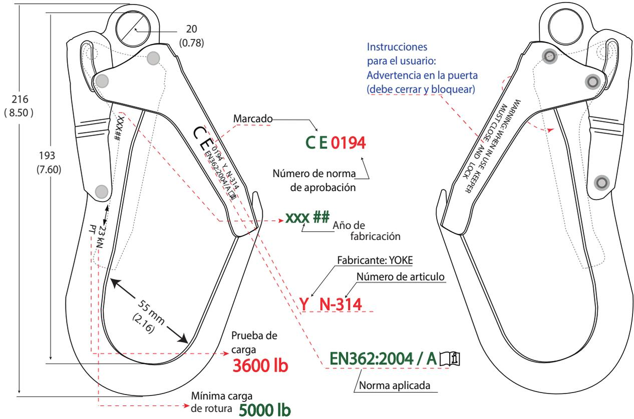
El acero usado, es previamente sometido a un análisis espectrográfico para asegurar, un contenido metalúrgico apropiado. Todos los componentes forjados son sometidos individualmente a una prueba de control Magnaflux para detectar rajaduras.
