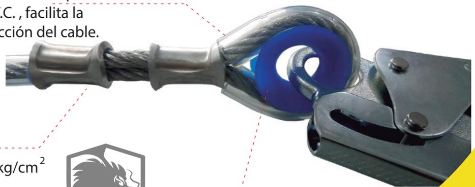
Prensado con férulas de aluminio ( con una presión de 100 kg/cm<sup>2</sup> )
