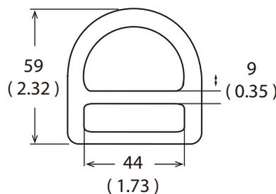
Los conectores de anclaje, están ideados para poder conectarse donde no exista un punto de anclaje, rodeando con la cinta una columna o estructura. La columna o estructura debe tener una resistencia a la tracción mayor a 5 000 lb
